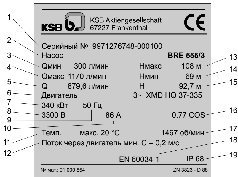
Рис. 2: Пример заводской таблички
