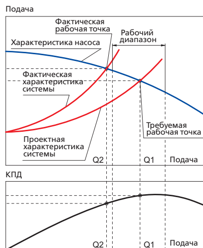
Рис. 12. Работа насоса при пониженной подаче
